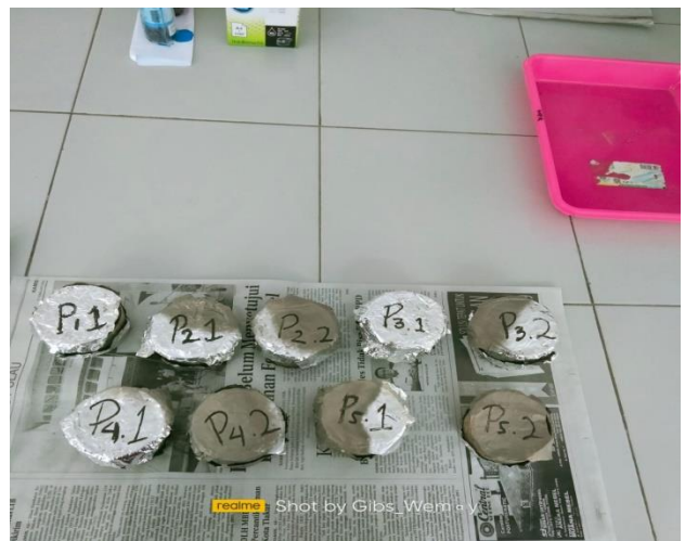
Penimbangan dan Pengovenan Sampel Tanah dengan Ring pada Laboratorium Tanah Fakultas Pertanian Unpatti
