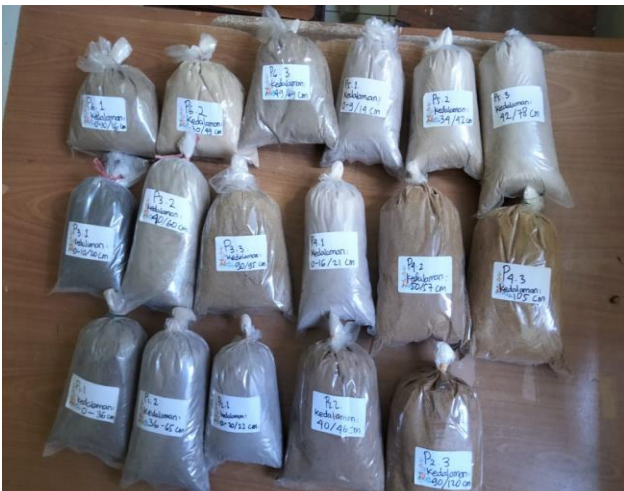
Penapisan dan Pemaketan Sampel Tanah untuk Pengujian di Laboratorium Maros, Sulawesi Selatan
