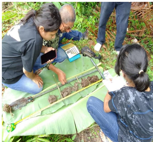
Kegiatan Kalsifikasi Profil Tanah, Dan Pengambilan Sampel Tanah Dengan Ring dan dengan Penggalan untuk Pengujian di Laboratorium Tanah
