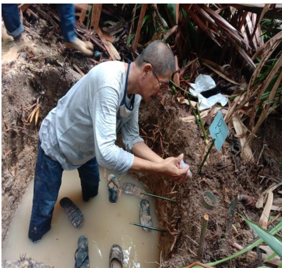
Kegiatan Kalsifikasi Profil Tanah, Dan Pengambilan Sampel Tanah Dengan Ring dan dengan Penggalan untuk Pengujian di Laboratorium Tanah
