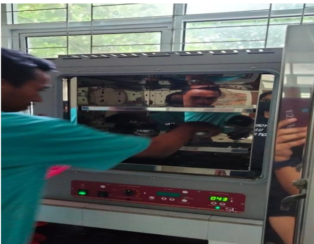
Penimbangan dan Pengovenan Sampel Tanah dengan Ring pada Laboratorium Tanah Fakultas Pertanian Unpatti
