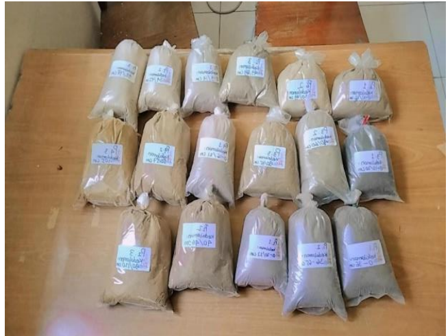
Penapisan dan Pemaketan Sampel Tanah untuk Pengujian di Laboratorium Maros, Sulawesi Selatan
